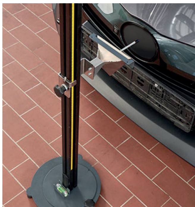
Höhenverstellung für den vorgegebenen mechanischen Zentrierpunkt am Fahrzeug
